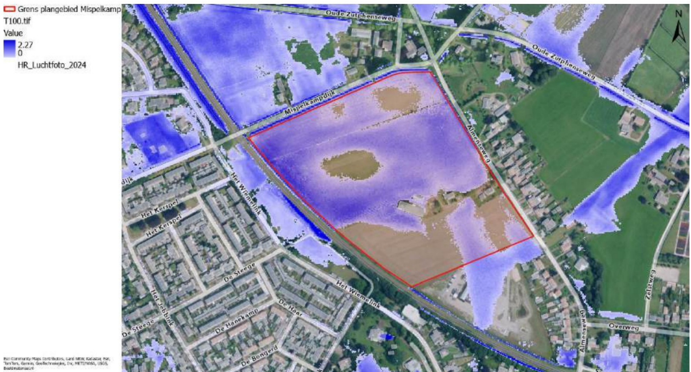
Figuur 3. Maximale waterdiepte water op maaiveld bij stresstest T=100 (70 mm in één uur)
